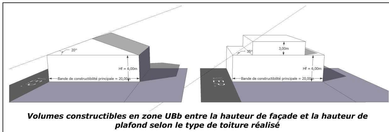
Le couronnement de la construction est défini par deux plans inclinés à 70% dont les points d'attache se situent au sommet du plan vertical de la hauteur des façades  $H_f$ .
