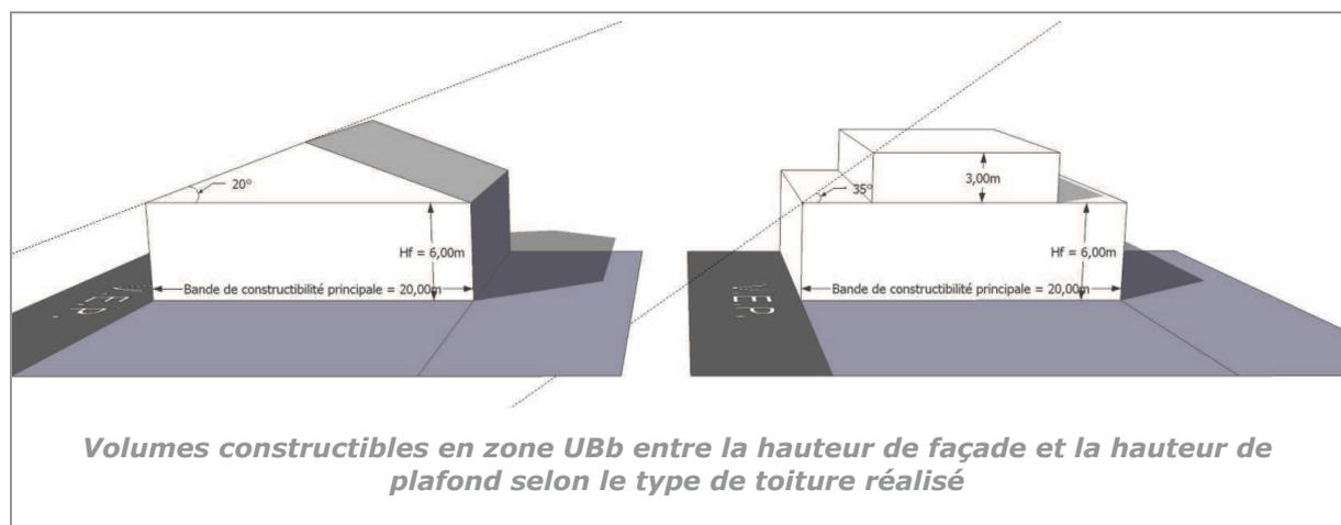
Le couronnement de la construction est défini par deux plans inclinés à 70% dont les points d'attache se situent au sommet du plan vertical de la hauteur des façades  $H_f$ .
